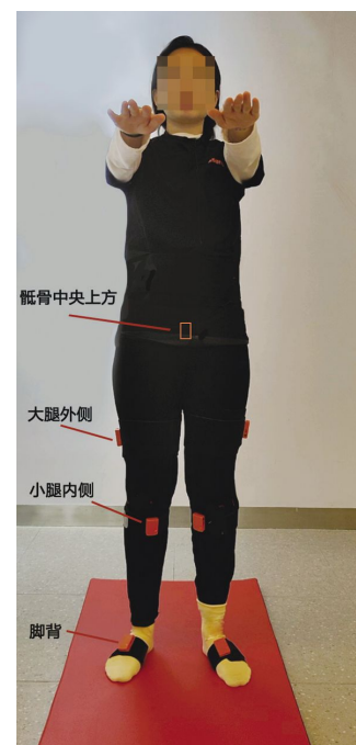
图 1 Xsens 使用部位图(安装在正面的仪器用实体表示,背面用线框表示)
